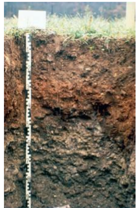
Bodenprofil 2: Häufig nasser oft zu wenig tragfähiger, schwarzer organischer Boden ohne drainierende Steine oder Kies. → häufig feuchtnasser, empfindlicher Boden.
