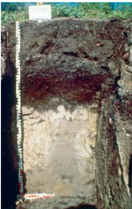
Bodenprofil 1: Mitteltiefgründiger Boden mit dunkelbraunem Oberboden (umgangssprachlich «Humus»), rostigfarbigem Unterboden und zuunterst dem toten, grauen Ausgangsmaterial («Muttergestein») → rasch abtrocknender, gut Wasserdurchlässiger Boden.
